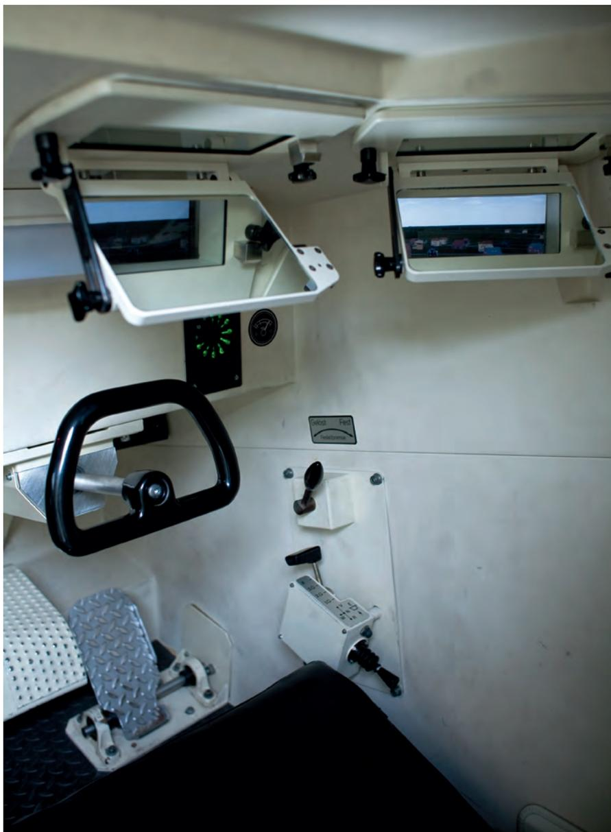
**Oben:** Die nachgebildete Fahrerkabine eines Kampfpanzers vom Typ Leopard 2. Das vor dem Fahrer liegende virtuelle Terrain wird über Spiegel in den Innenraum geleitet
